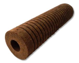
Constituído de fibras impregnadas com resina, que formam uma estrutura de porosidade diferenciada e decrescente da parte externa para a interna. Esta disposição proporciona um tratamento progressivo do fluido, fazendo com que as partículas maiores fiquem retidas na
